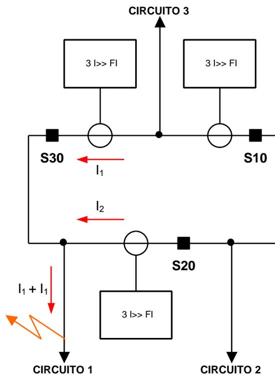
Figura 28 Ajuste relé de falla interruptor configuración en anillo
