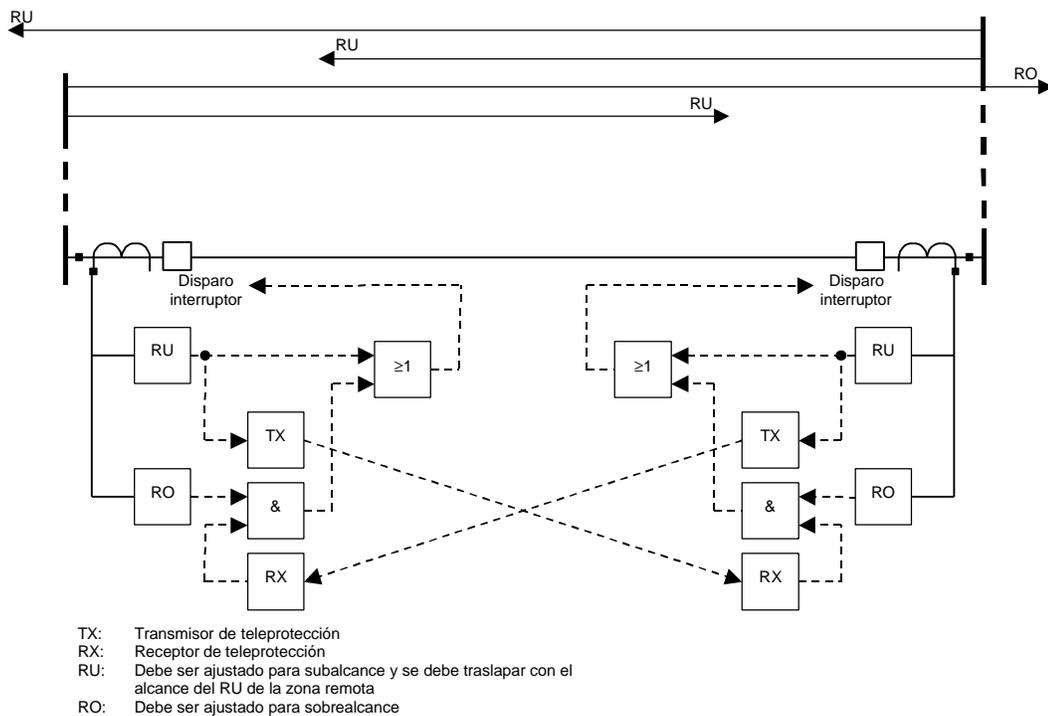
**Figura 13 Esquema de disparo permisivo subalcanzado**
