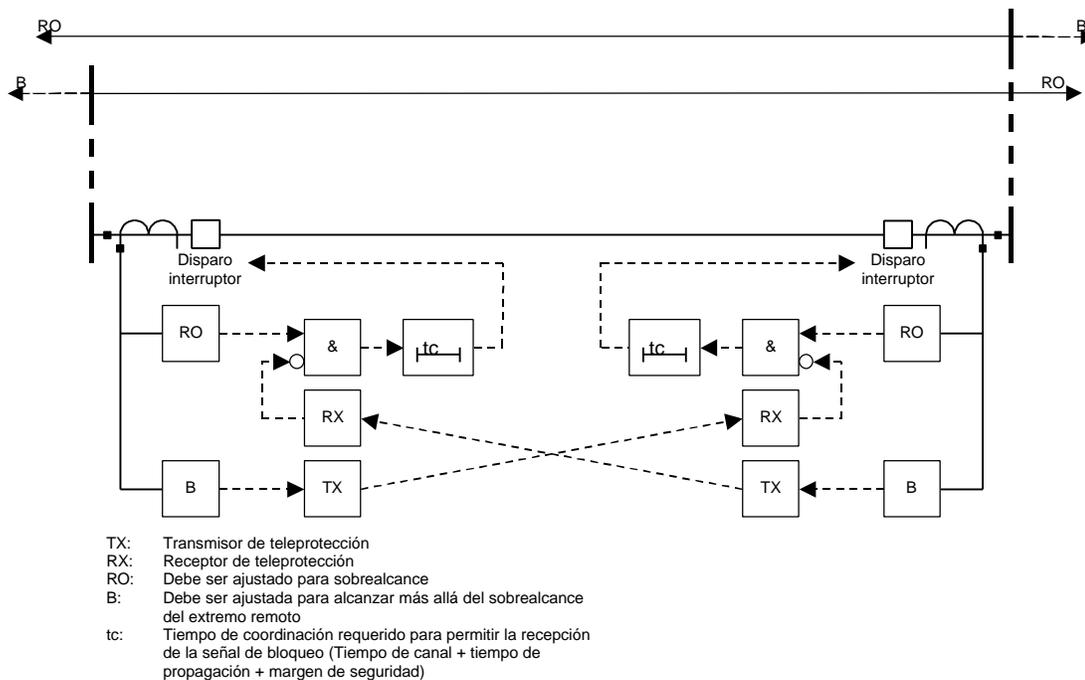
**Figura 17 Esquema de bloqueo por comparación direccional**
