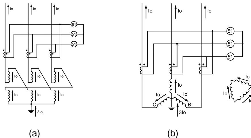
**Figura 45 Protección de transformadores de tierra (a) Zigzag (b) U- D**
