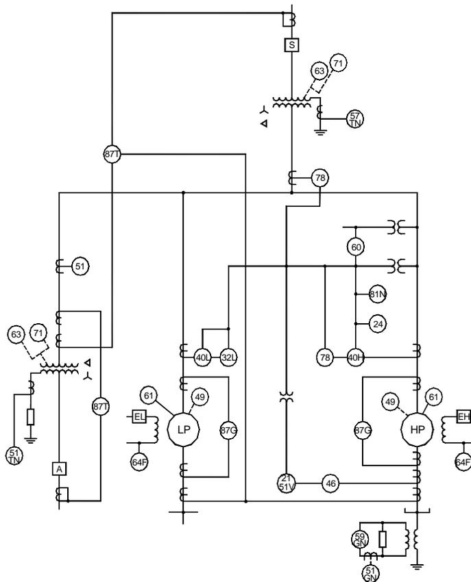
**Figura 87 Generadores compuestos**
