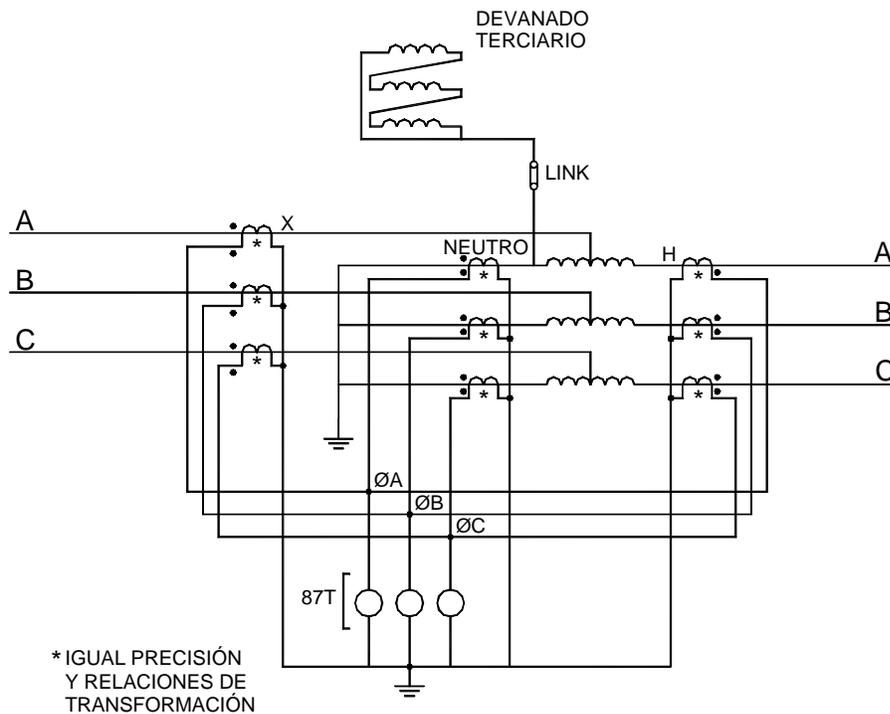
**Figura 40 Protección diferencial de alta impedancia para un autotransformador sin carga en el terciario**
