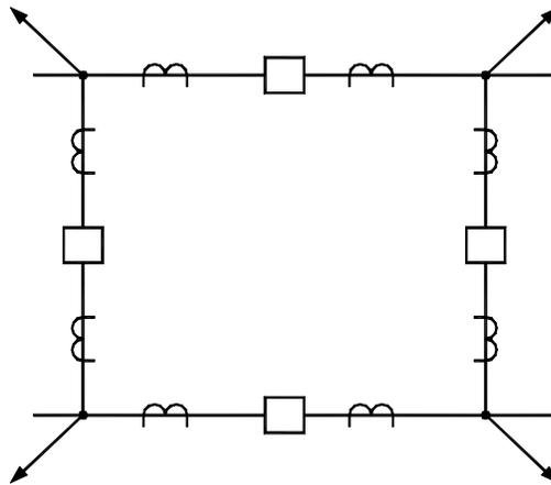
**Figura 93 Configuración en anillo**
