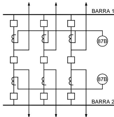
**Figura 98 Protección diferencial en una S/E interruptor y medio**
