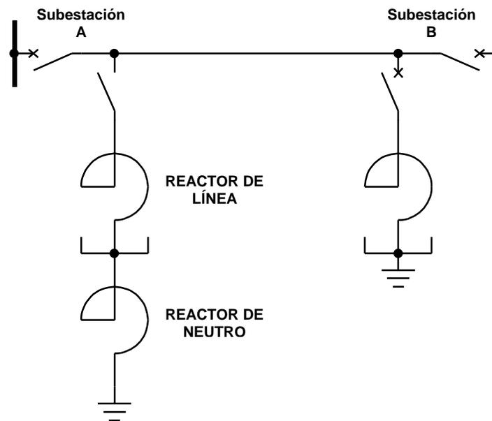
Figura 49 Reactor con o sin reactor de neutro y conectado a una línea conmutable o no
