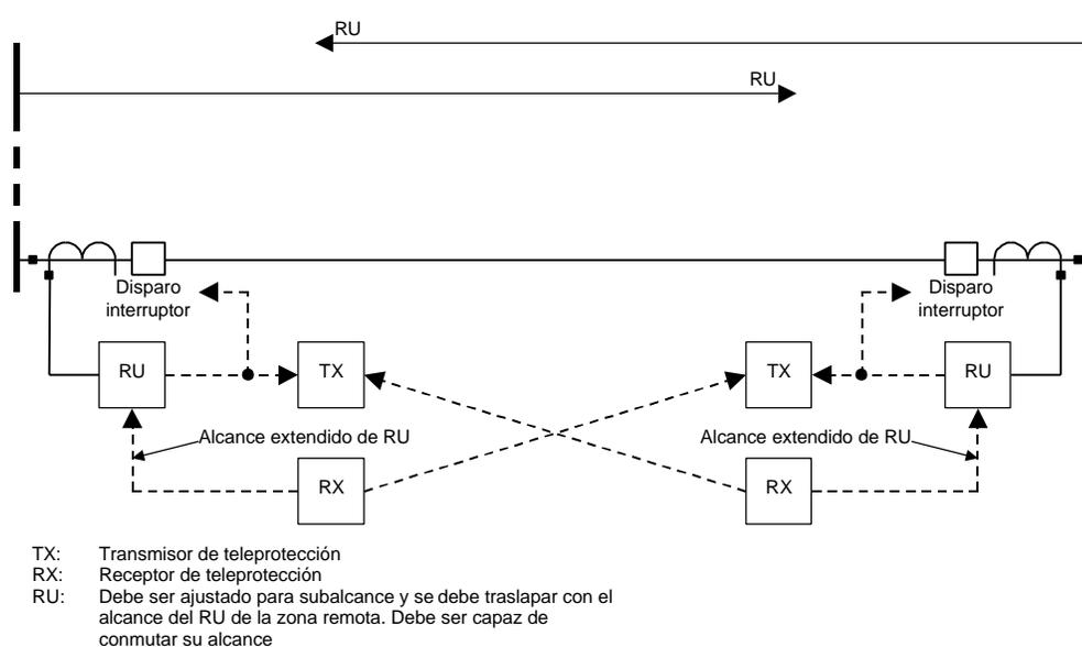
**Figura 15 Esquema de aceleración de zona**
