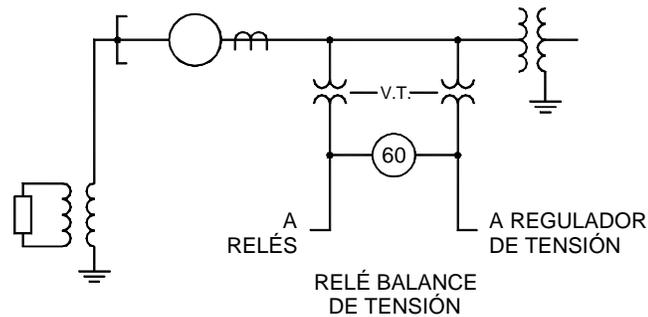
**Figura 76 Aplicación de relé de balance de tensión**
