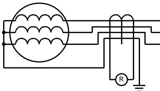
**Figura 57 Esquema de conexión de la protección de autobalanceo**
