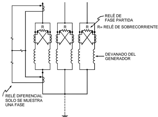
**Figura 65 Aplicación de relé diferencial y relé de fase partida**
