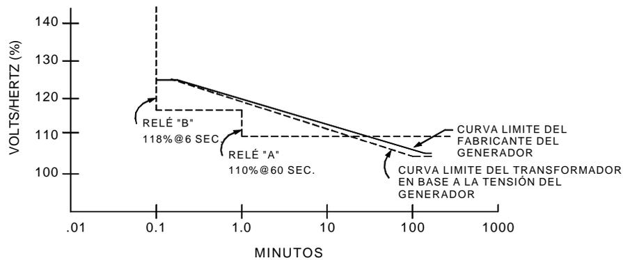
**Figura 77 Ejemplo ajuste de nivel dual volts / Hz**
