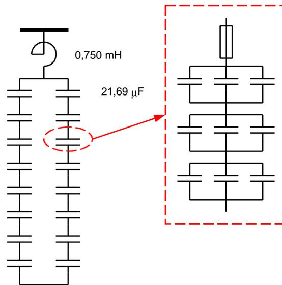
**Figura 52 Configuración física de un banco de condensadores**
