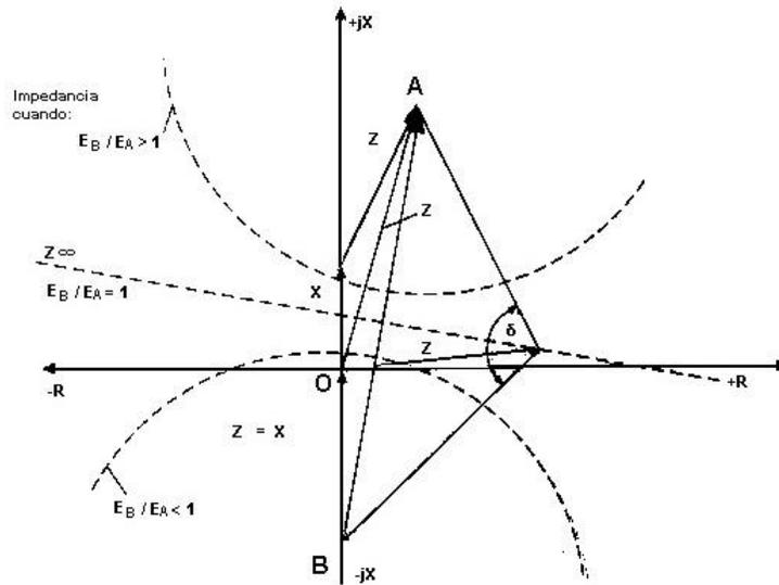
Figura 101 Lugar geométrico de la impedancia en un deslizamiento polar
