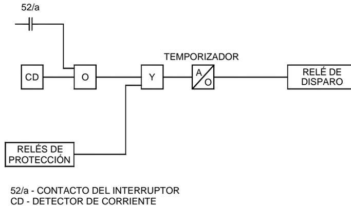
**Figura 83 Diagrama funcional de esquema de falla interruptor para generador**
