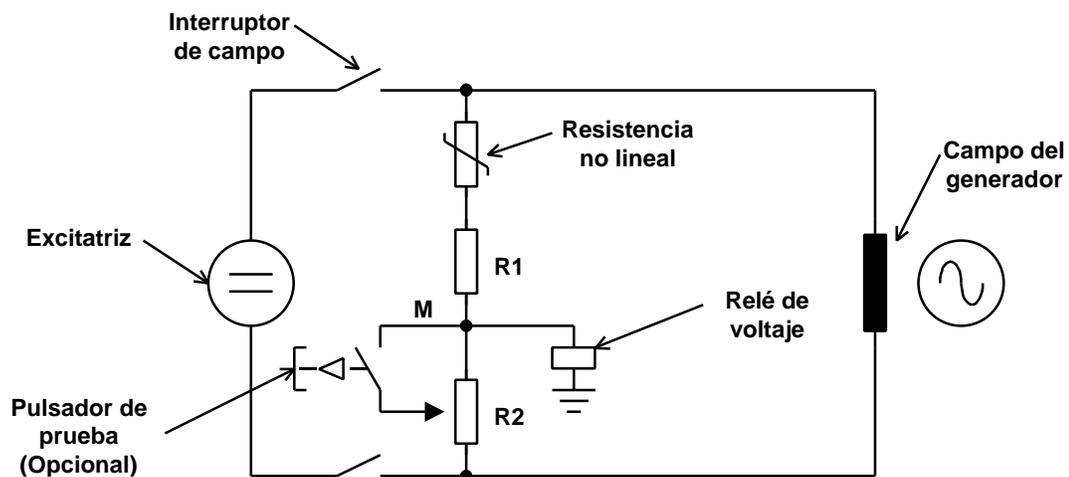
**Figura 75 Circuito de detección de tierra**
