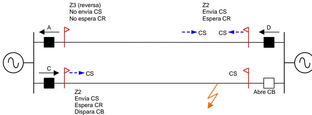
**Figura 20. Lógica de inversión de corriente: postinversión**
