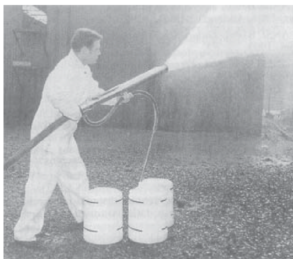
Ilustración A.3.3.24.3(b) Boquilla de Manguera de Espuma de Aire con Proporcionador Incorporado.
