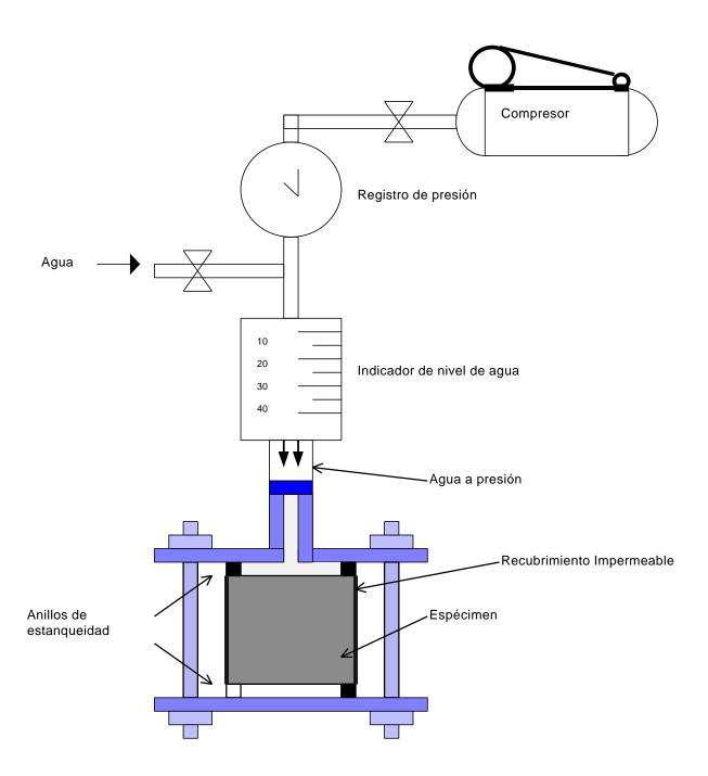
Figura 1. Dispositivo de ensayo
