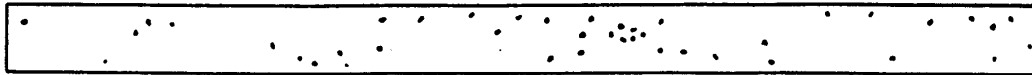
Tamaño y cantidad permitida en un longitud de 6" de soldadura Espesor de 0.125" a 0.25"
