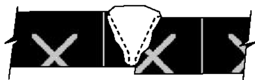
Penetración inadecuada debido a desalineamiento en alturas
