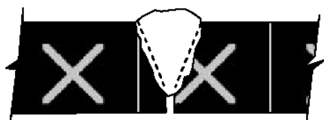
Penetración inadecuada de la soldadura en ranura
