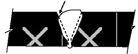
Penetración incompleta de soldadura en ranura
