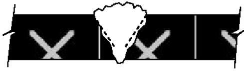
Ondulado excesivo en la soldadura
