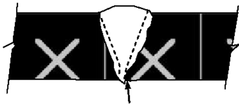
Fusión incompleta del paso de fondeo
