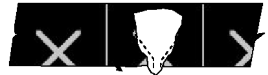
Fusión incompleta (en la parte superior de la soldadura en ranura)
